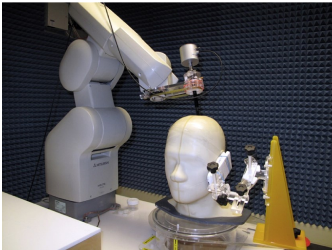
Abb. 6: SAR-HF (Hochfrequenz)-Testsystem für Mobiltelefone unter Verwendung eines Kopfmodells (Specific Anthropomorphic Mannequin).
